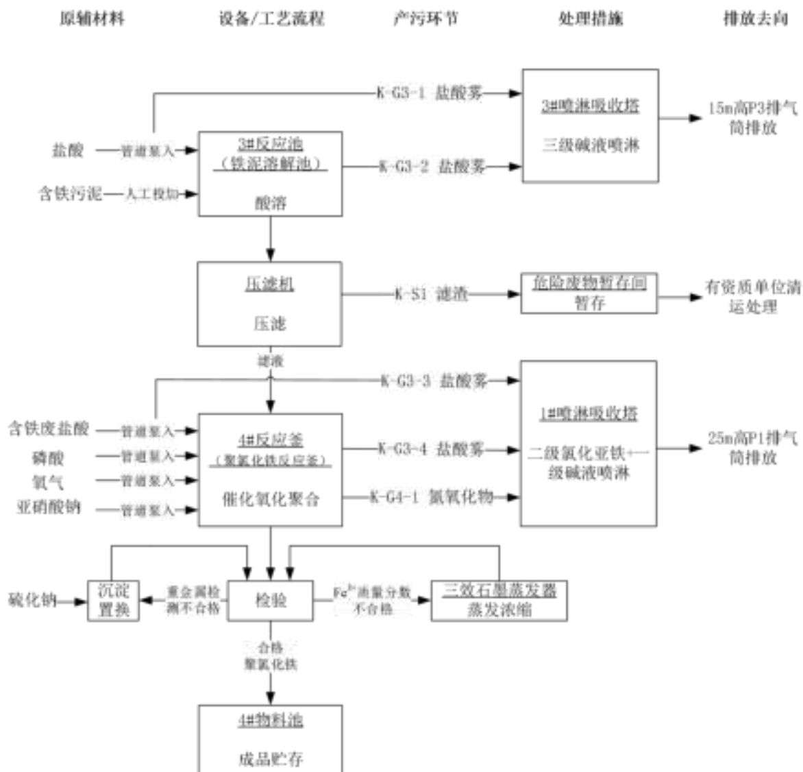
图 2.4-5 聚氯化铁生产工艺流程图
